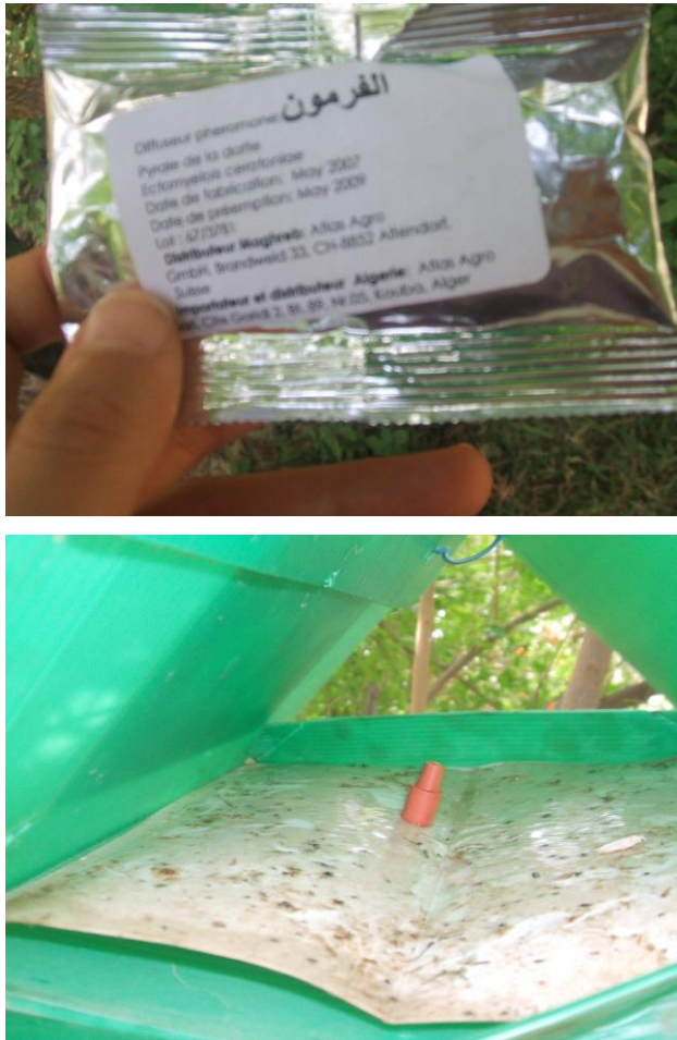
Figure 8: les différentes composantes du piège à phéromone.
