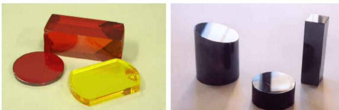
**Figure 1.3 :** Verres de sulfures (à gauche) et séléniures (à droite).
