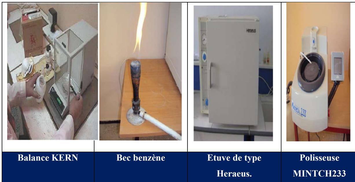
Figure 1.9 : Dispositifs expérimentaux utilisés pour synthèse des verres.
