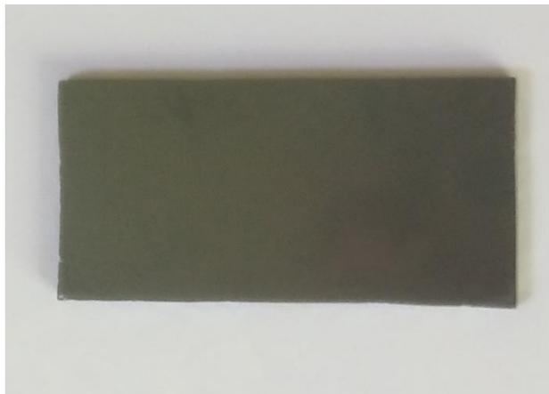
**Figure II.1** : Image de filme mince de  $\text{Co}_3\text{O}_4$  à  $T=400^\circ\text{C}$
