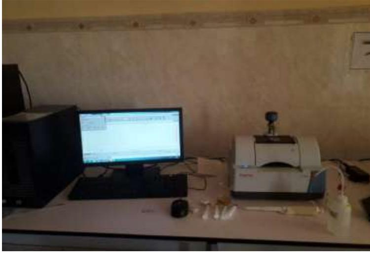
الشكل 42. جهاز مطيافية الأشعة تحت الحمراء IR
