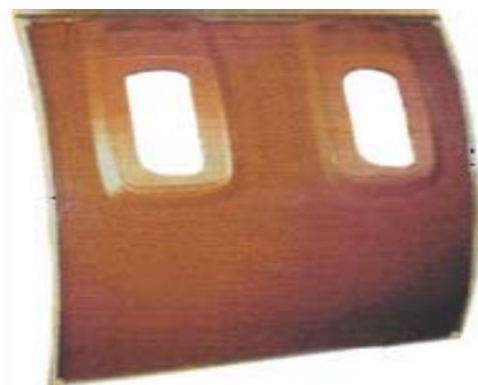
Fig. I.15 Pièce aménagement intérieur d'avion en composite tissu de fibres de verre dans une résine phénolique [1]
