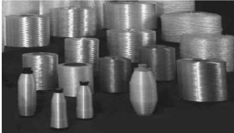
Fig. I.12 Bobines de fibre de verre, roving et silionne [1]
