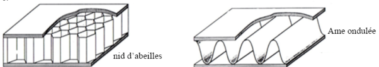
Fig. I.24 Matériaux sandwiches à âmes creuses
