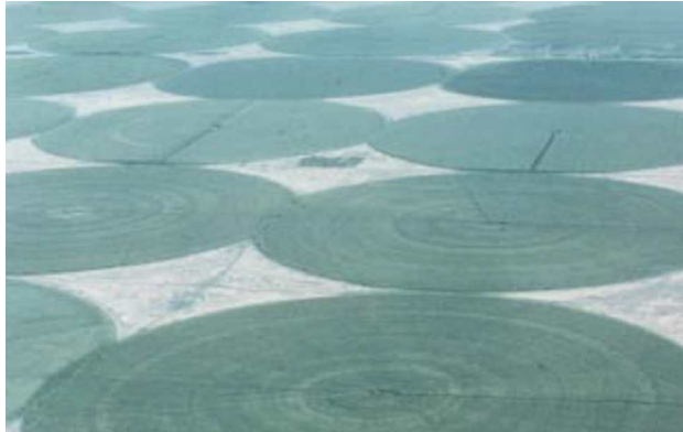
Fig.2.18- Irrigation par rampes pivotantes de secteur recevant des doses différentes [5].
