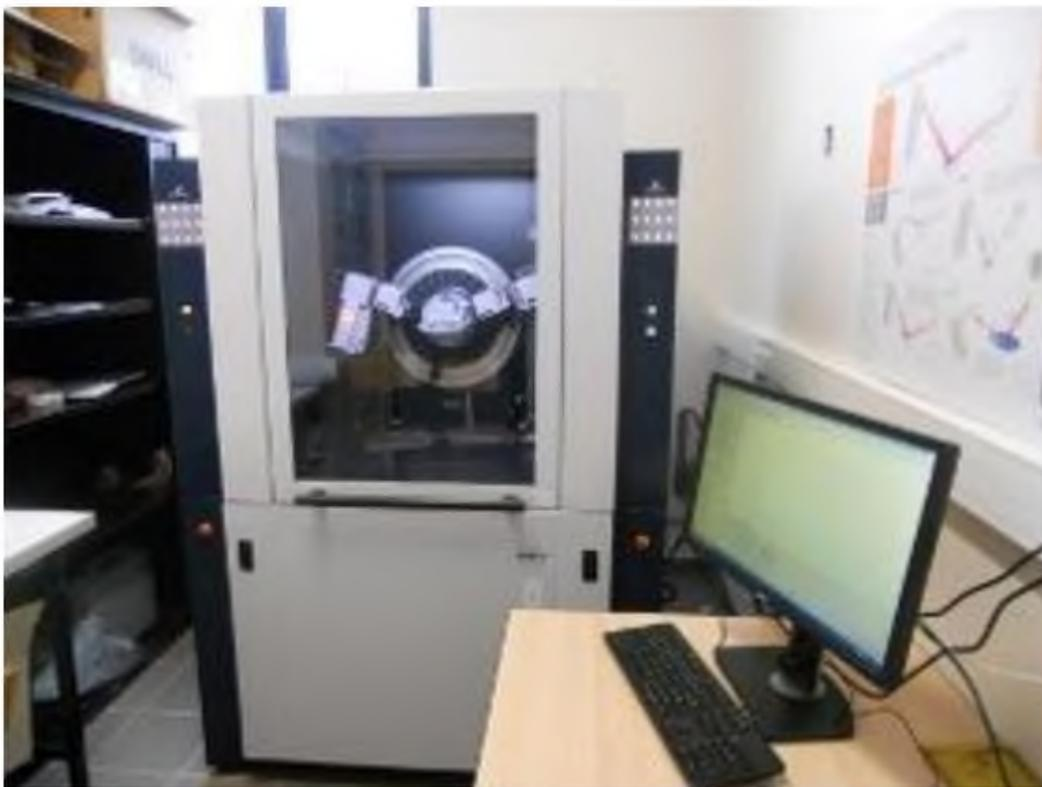
**Figure II.4:** diffractomètre de type : D8 Advance Bruker.
