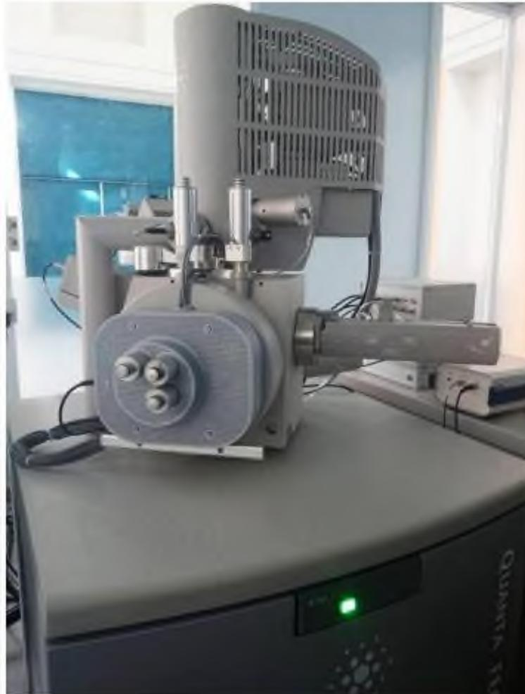
**Figure II.10:** Microscope électronique à balayage ESEM-FEI Quanta 600 FEG.
