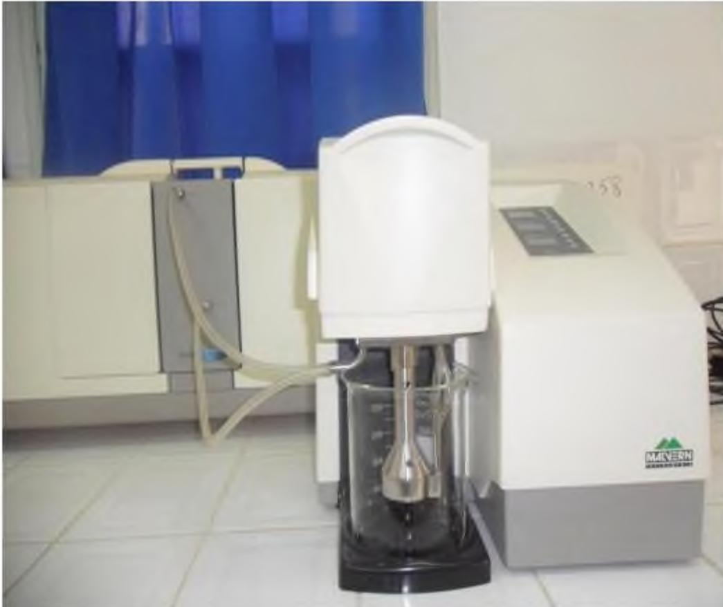
**Figure II.7:** Granulomètre laser Malvern Mastersizer 2000/3000.
