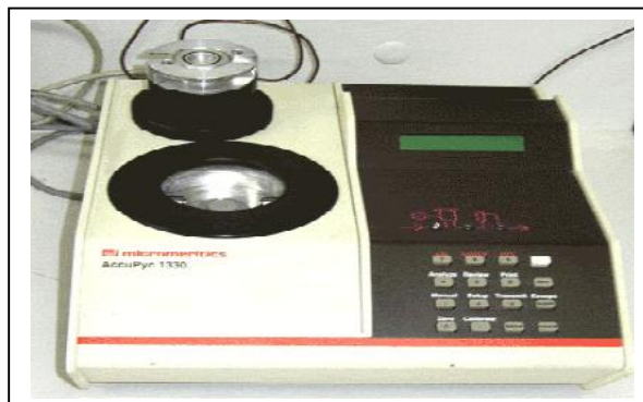
Figure II. 9: Pycnomètre à Hélium, AccuPyc1330. (LMP. Univ. RENNES1 (FRANCE)).
