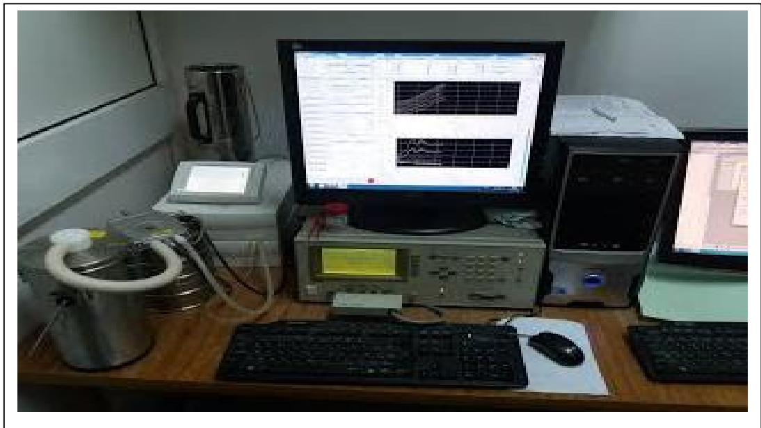
Figure II. 24: Pont d'impédance et cellule de mesures diélectriques de type HP/Agilent 4284A. (LMF-SFAX).
