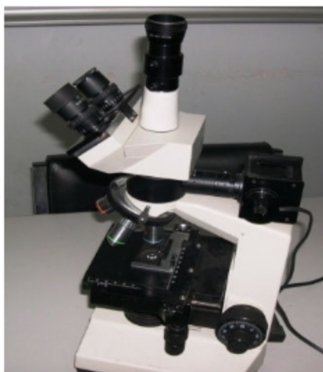
Figure 4: Microscope métallographique de type Olympus (Laboratoire de physique, Univ -Biskra).
