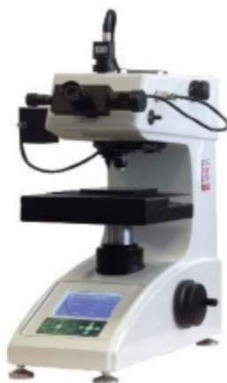
Figure 6: Microdureté Vickers du type 402MVD (Laboratoire de physique, Univ -Biskra).
