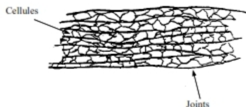
Figure 17 : Structure lamellaire observée pour les forts taux de déformation [Hughes et Hansen 1997].
