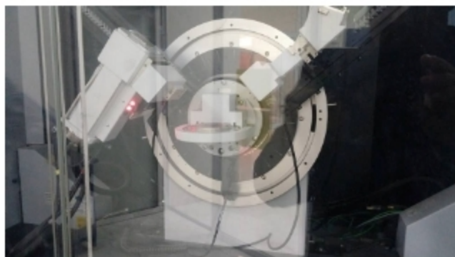
Figure 10: Diffractomètre de type PAN alytical X' Pert PRO. (Laboratoire de physique, Univ -Biskra).
