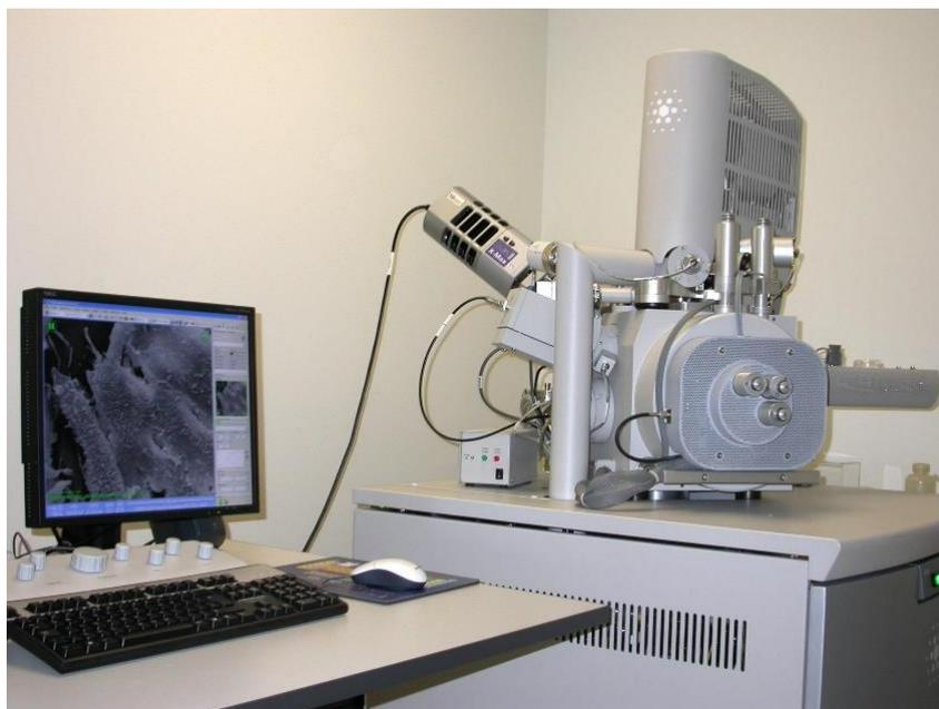
**Figure III.5.** Appareil microscope à balayage
