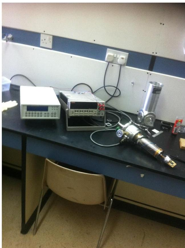
**Figure IV.3.** Les parties principales de l'installation de la technique de quatre pointes.
