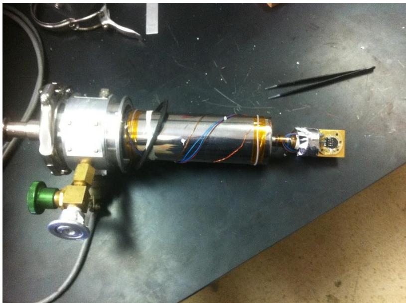
**Figure IV.2.** Echantillon fixé sur le porte-échantillon du cryostat
