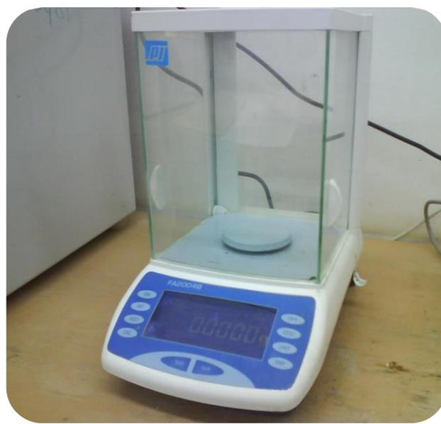
Figure(II.3): Balance électronique de précision de sensibilité (0,0001g).....FA2004B
