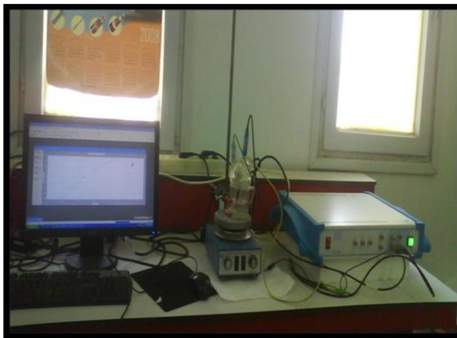
**Figure (II. 9): Montage pour le tracé des spectroscopies d'impédance électrochimique**
