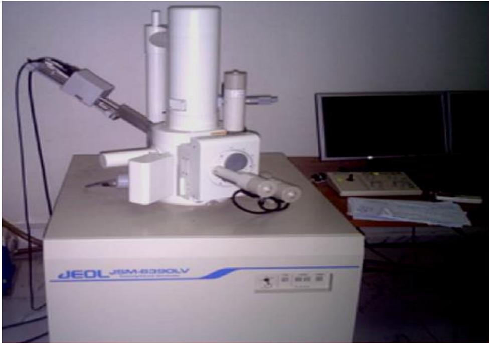
**Figure (II. 12) : Microscopie électronique à balayage (MEB) de type Jeol JSM-6390LV**
