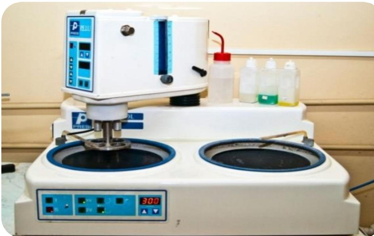
Figure (II.1) : Une polisseuse mécanique
