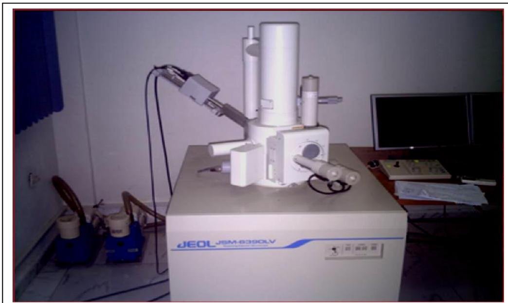
Fig. III.10. Microscopie électronique à balayage de type JEOL JSM-6390LV.
