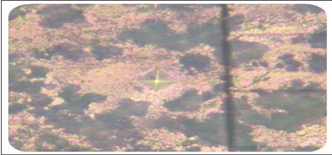
**Fig. III. 5. Empreinte réalisée sur une éprouvette**
