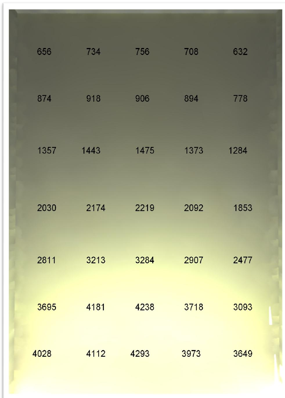
**Figure VIII.16: Valeurs d'éclairagements sur le plan de travail simulé par 'Radiance' de bureau équipé de Light shelf, orientation Sud, pour le mois de septembre à 12h (Source : Auteur)**
