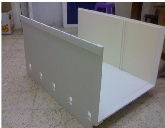
**Figure VIII.3: Les ouvertures dans les parois pour placer les sondes des luxmètres. (Source: Auteur)**
