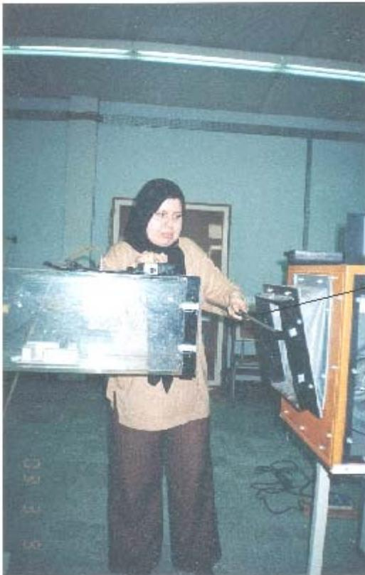
Mesurer la vitesse des rafales d'air produits par le générateur ( le souffleur) de l'air du banc thermo-fluide par un anémomètre.
