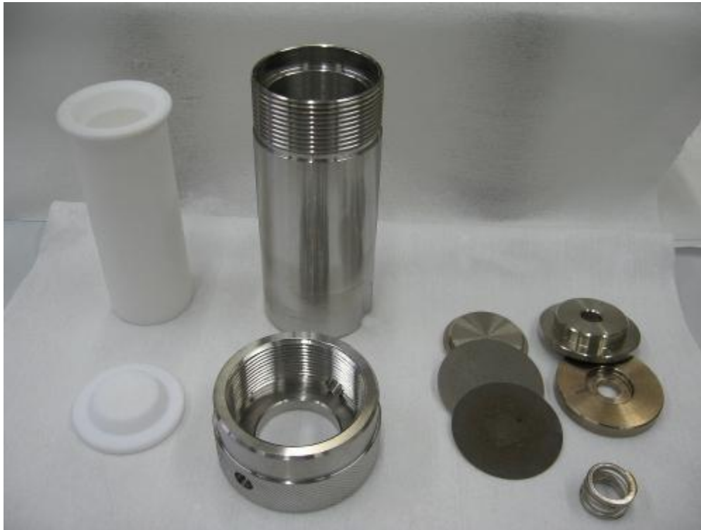
Figure III.2 – Réacteur hydrothermal : la réaction se déroule dans le récipient en téflon
