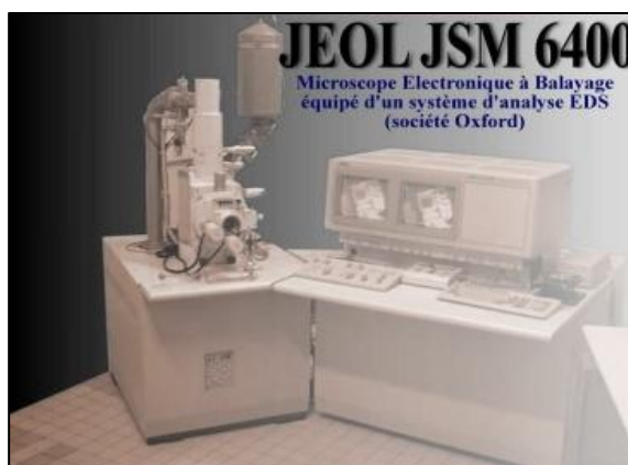
Figure III.12: Microscope électronique à balayage JEOL, modèle JSM 6400 équipé d'un système d'analyse EDS.
