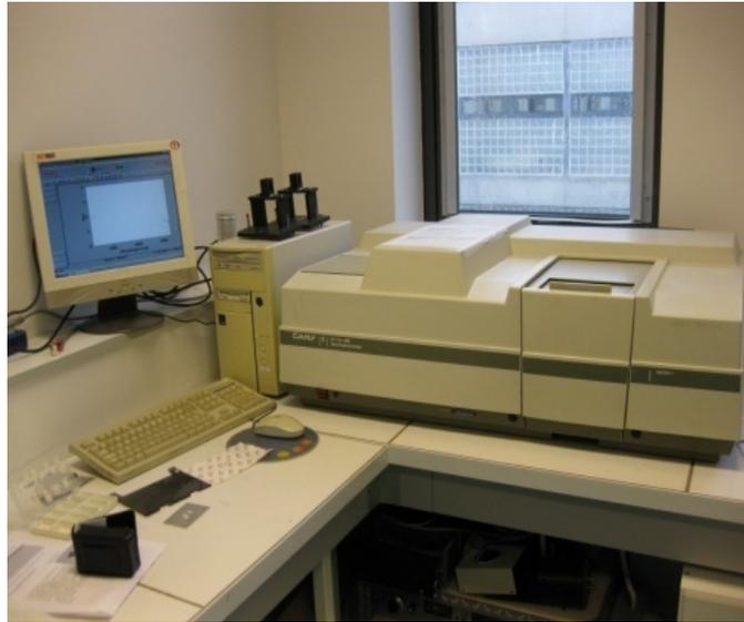
**Figure II.12 :** Spectrophotomètre UV-V-NIR Carry 5
