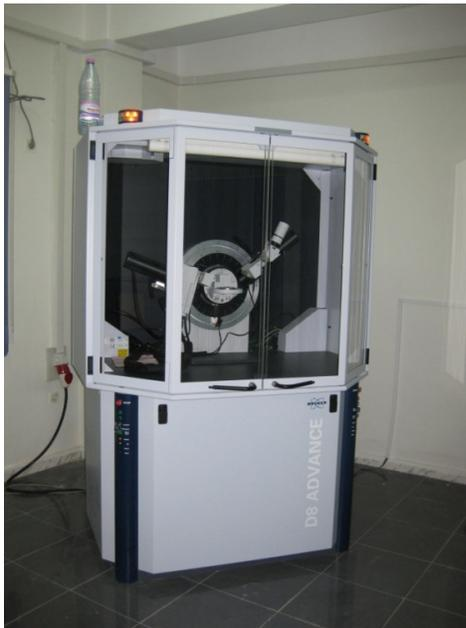
**Figure II.1:** Diffractomètre à rayons X de type Bruker D8 ADVANCE.
