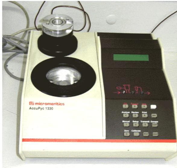
**Figure II.5** : Pycnomètre à hélium modèle ACCUPYC 1330 MICROMERITICS.
