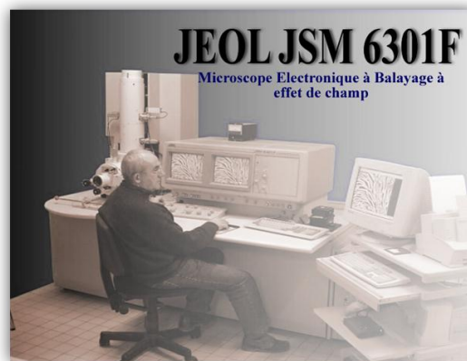
Fig. III.12: JEOL, model JSM 6301F microscope électronique à balayage à effet de champ.
