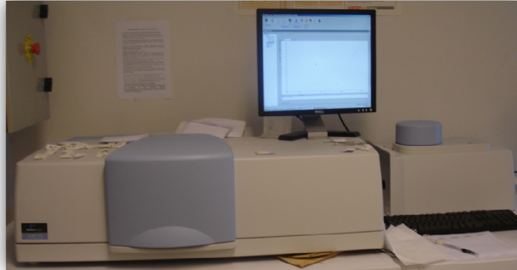
Fig II.14 : le spectrophotomètre de type (UV-3101 PC-SHIMADZU)
