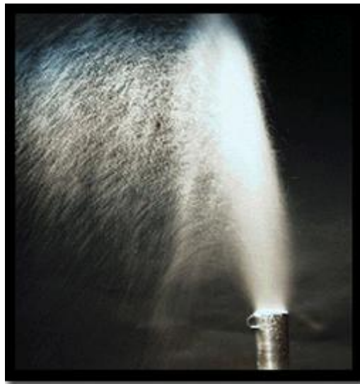
FigII.1 : Pulvérisation ultrasonique des liquide [82]
