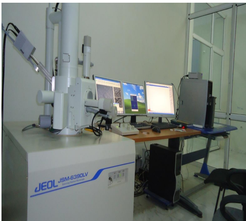
Figure II.9: Microscope électronique à balayage JEOL JSM.6390L
