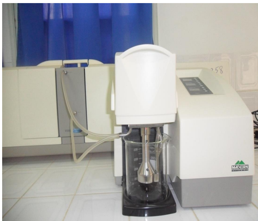
Figure II.5 : Granulomètre laser Malvern Mastersizer 2000/3000.
