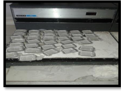
Figure 63. Remplissage des moules sur la plaque froide
