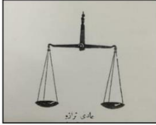
ميزان ذو كفتين يسما (الطرازو ذو كفتين) يصنع من الحديد أو البرنج.
