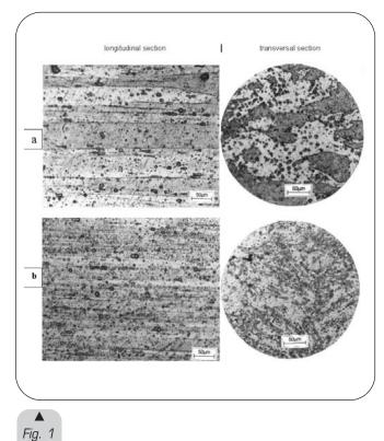
**Microstructures of aluminum wire after reduction by cold wire drawing:** (a)  $\varepsilon = 17$  %, (b)  $\varepsilon = 92$  %. Microstrutture di fili di alluminio dopo riduzione mediante trafilatura a freddo: (a)  $\varepsilon = 17$  %, (b)  $\varepsilon = 92$  %.
