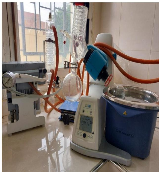
Figure 11 . Montage d'évaporation d'extraits méthanolique
