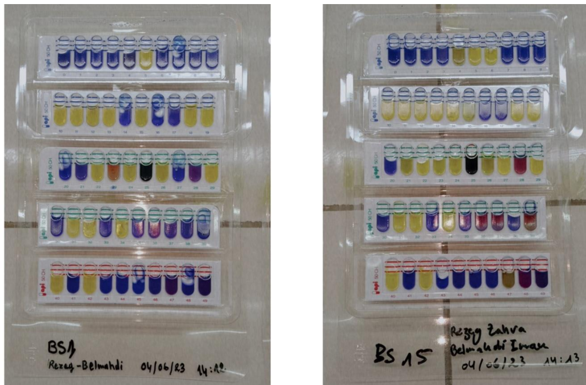
Figure 13. Résultats de l'identification par API 50 CHL de deux isolats BS1, BS15 (Original, 2023).
