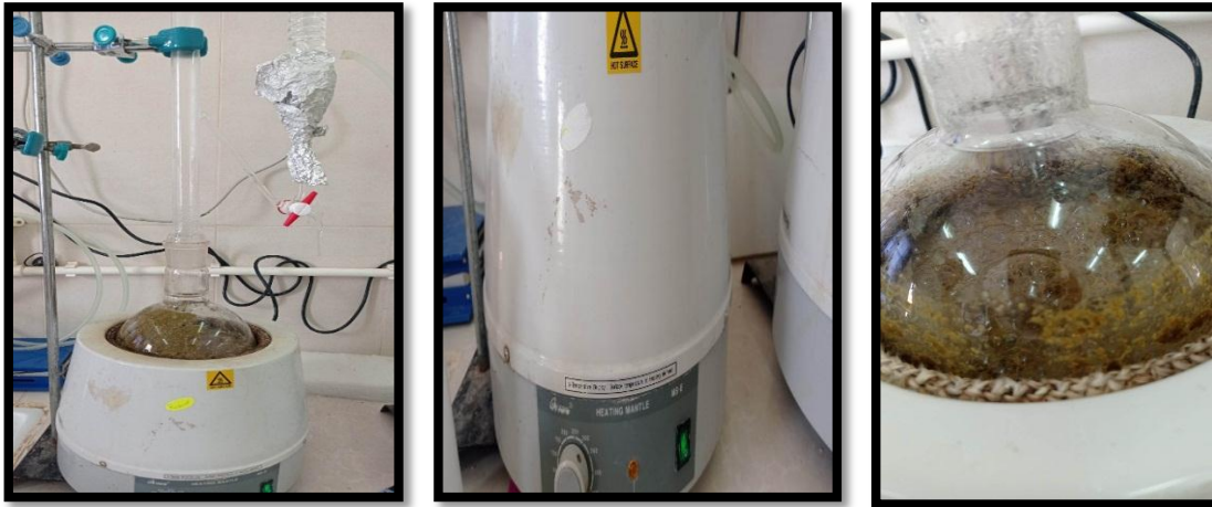
Figure 6. Extraction des huiles essentiels par appareil de type Clevenger
