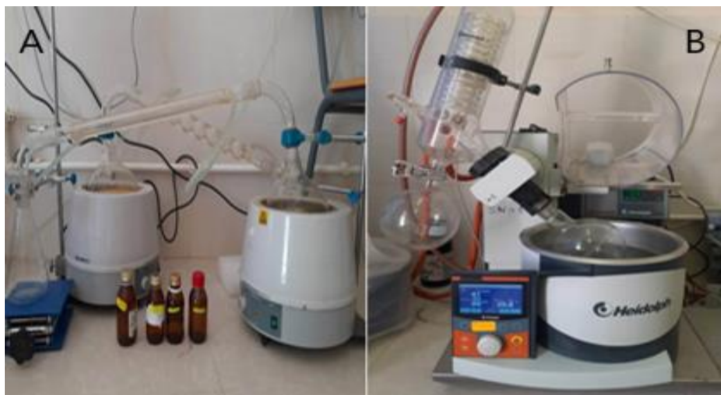
Figure 7. Montage de hydro distillation (A) et d'évaporateur rotatif (B).
