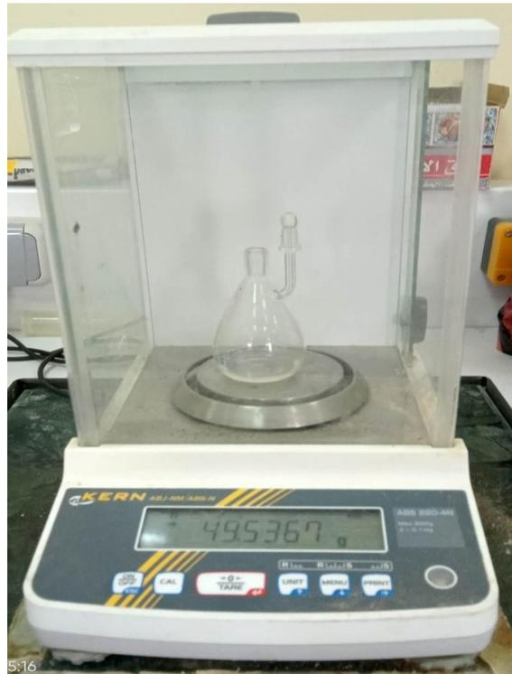
**Figure IV.13** Mesure la densité par pycnomètre. (Originale)
