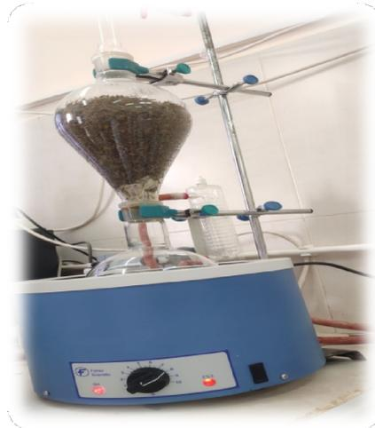
**Figure 3:** Extraction des huiles par entrainement à la vapeur clevenger.
