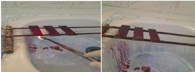
Figure 12: Les lames Chauffent par le dessous au moyen de la flamme d'un bec Bunsen (SCTMR, 2023)
