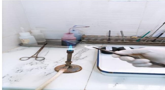
Figure 9: La fixation des lames séchées sur la flamme (SCTMR, 2023)
