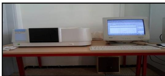
**Figure II.7:** Spectromètre Infrarouge à transformée de Fourier Shimadzu 8400s [16]
