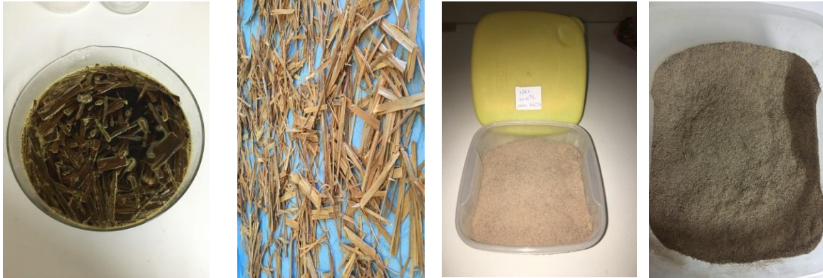
Figure III.10 : Préparation des fibres de palmier dattier DPLF traitées avec une solution de NaOH à 6%
