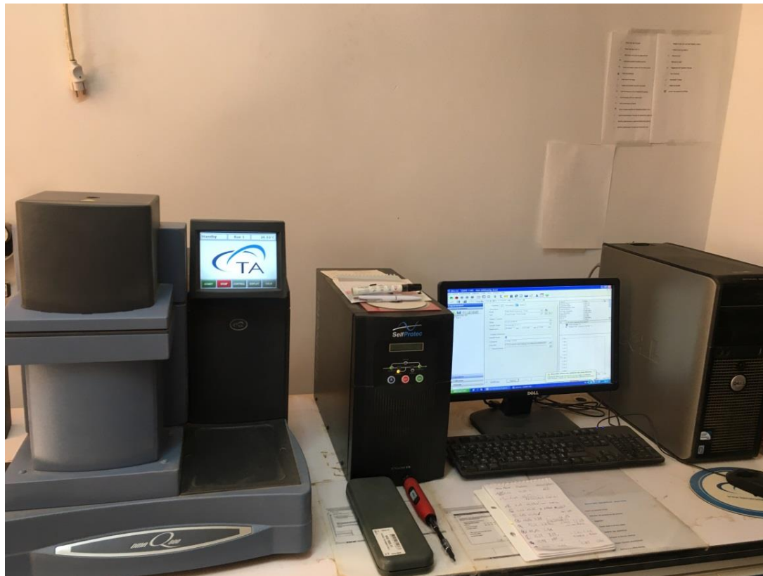
Figure III.18 : Instrument du DMA (analyse mécanique dynamique) de type TA, Q800
