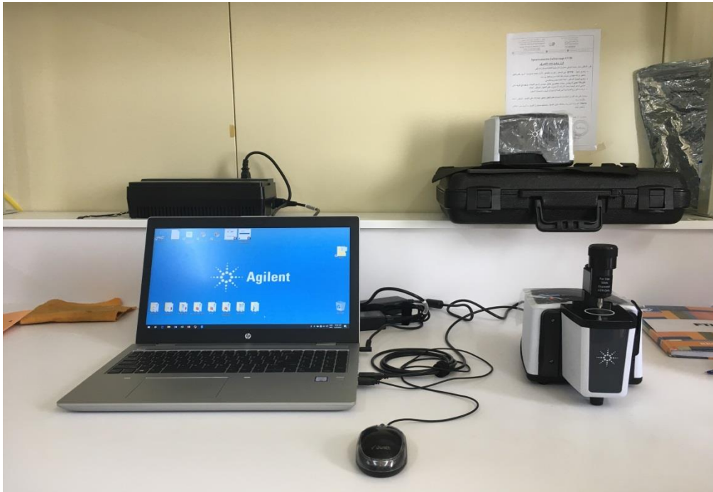
Figure III.14 : Spectromètre Agilent Cary 630 FTIR
