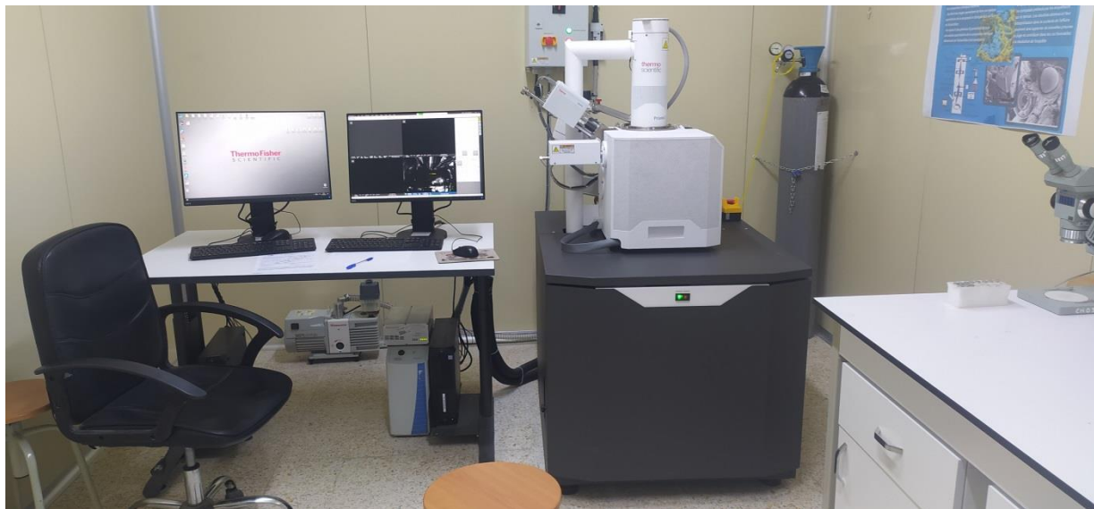
Figure III.16 : Microscope électronique à balayage (MEB/EDX) de type Thermo Fisher Prisma E
