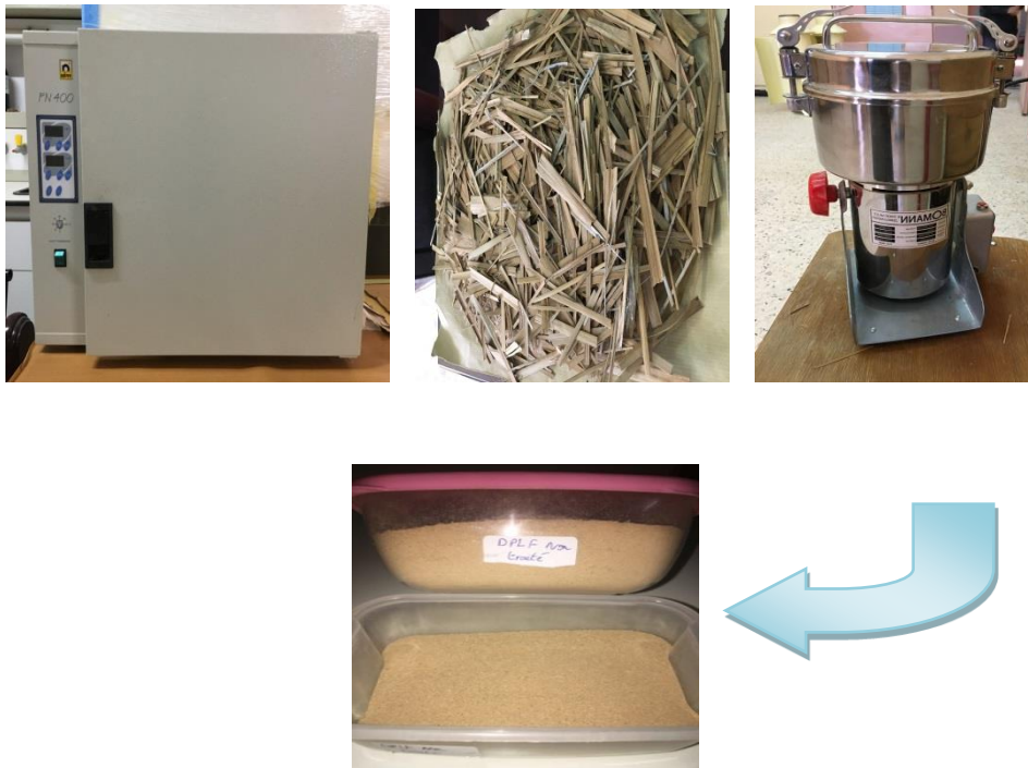
Figure III.9 : Préparation des fibres de palmier dattier
