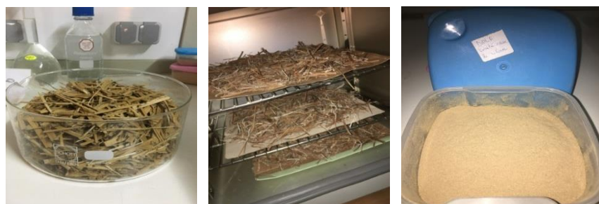
Figure III.11: Préparation des fibres de palmier dattier DPLF traitées avec le silane 1%
