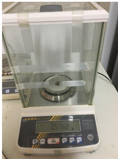
Figure III.17 : Test d'absorption d'eau
