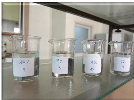
**Photo III-12** :L'acier x70 dans un milieu acide HCl sans inhibiteur
