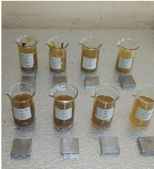
**Photo III-13** : L'acier x70 dans un milieu acide HCl avec inhibiteur
