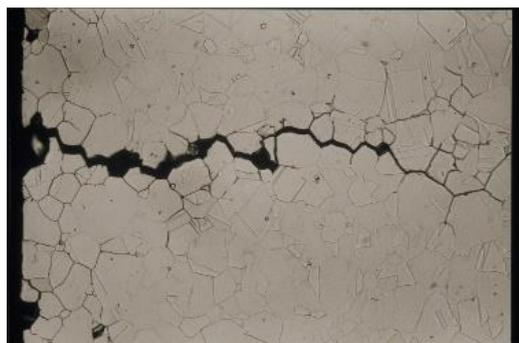
**Figure I-10:** Corrosion sous contrainte
