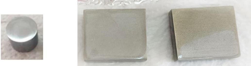
**Photo III-11** : L'échantillon après polissage
