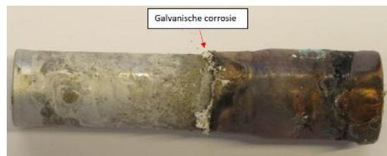
**Figure I-4 : Corrosion galvanique**
