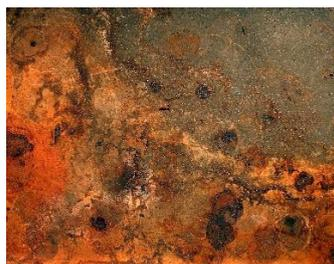
**Figure I-3 : corrosion localisée**
