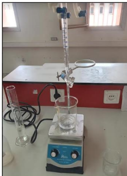
L'ajout à S3 de l'éthanol goutte à goutte
