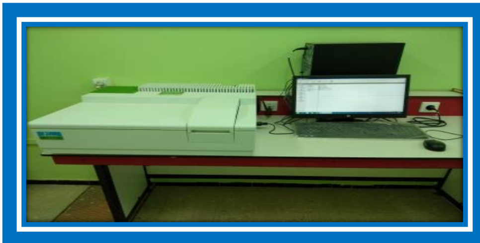
Figure II.11 : (a) Le principe de spectrophotomètre. (b) Spectromètre UV-VISIBLE.
