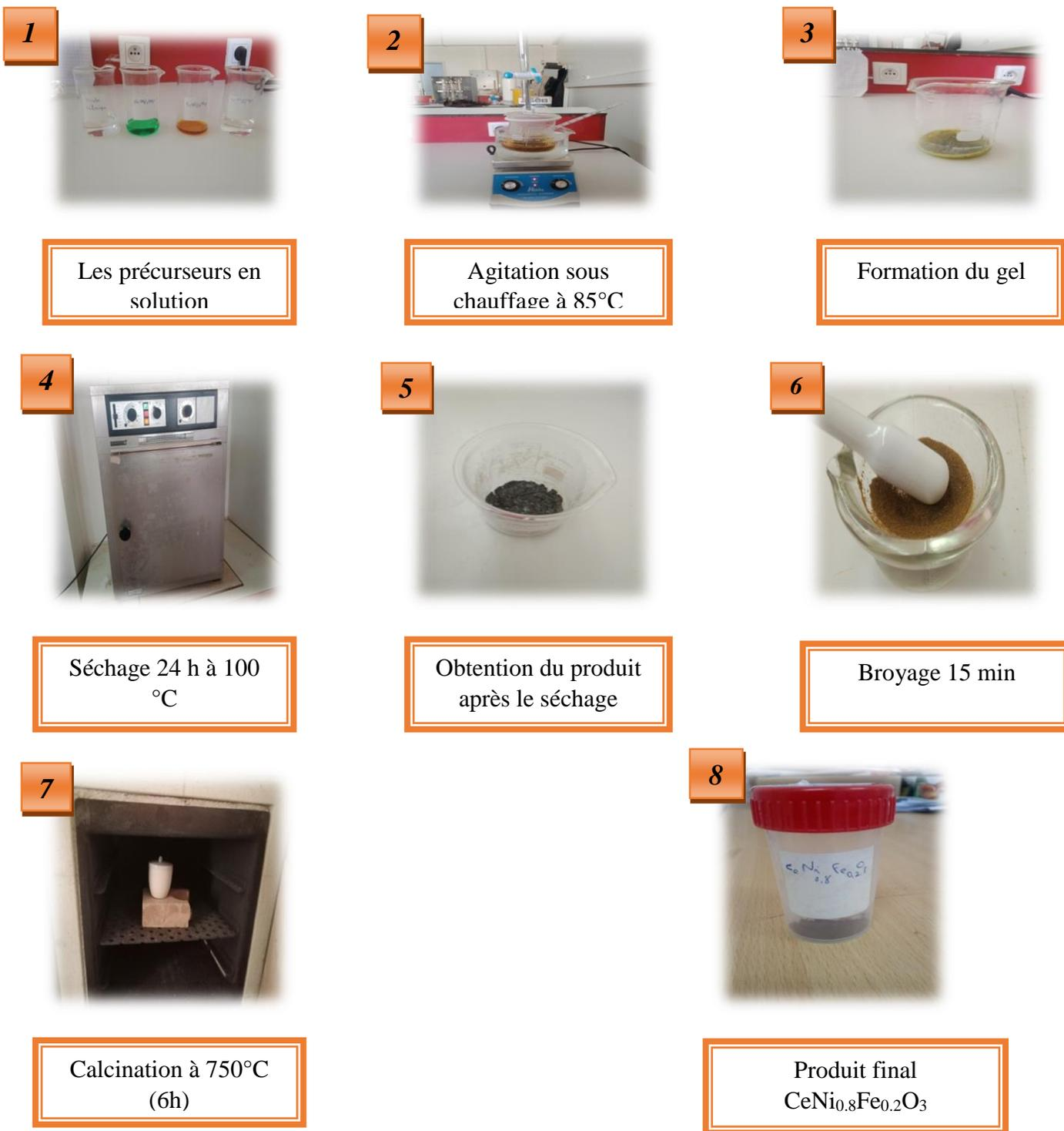
**Figure III.3 :** Différentes étapes de préparation de la poudre  $\text{CeNi}_{0.8}\text{Fe}_{0.2}\text{O}_3$  par méthode sol-gel.
