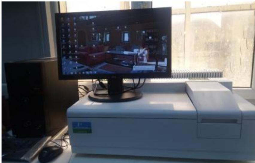
**Figure II.7.** Spectrophotomètre Uv -Visible
