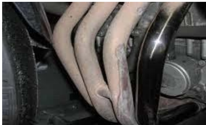
Fig I.2 : Exemple de la corrosion d'un collecteur d'échappement.
