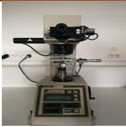
Fig III.5: Dispositif utilisé pour la mesure de la micro dureté.
