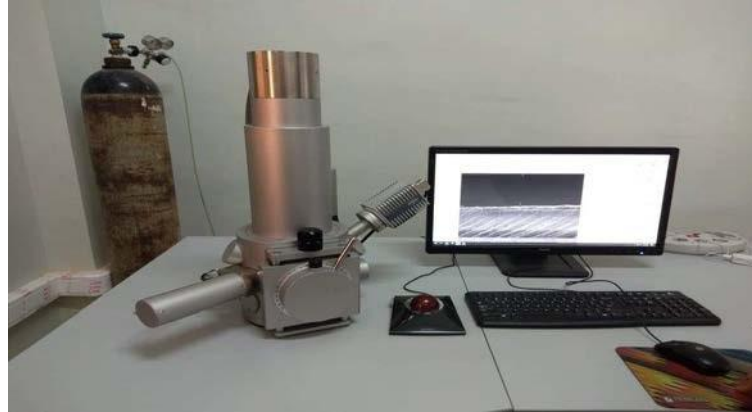
Fig III.9. Microscope électronique à balayage (MEB) (laboratoire de recherche LPCMA, université de Biskra)
