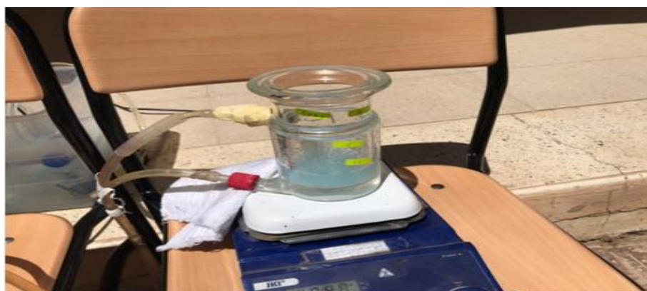
Figure II. 9: Schéma du réacteur photocatalytique.
