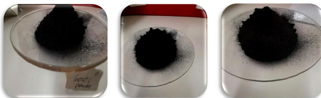
Figure. II.13 CAP(600°C ,500°C,400°C) après séchage
