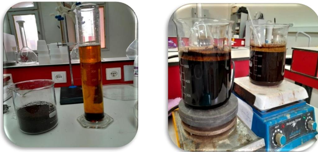
**Figure. II.8** Les grains et poudres activés chimiquement
