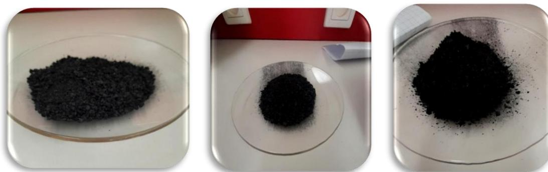
Figure. II.12 CAG(600°C ,500°C,400°C) après séchage
