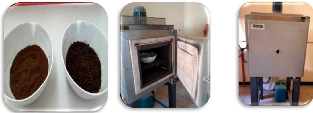
**Figure. II.9** Calcination des CAP et des CAG dans le four moufle
