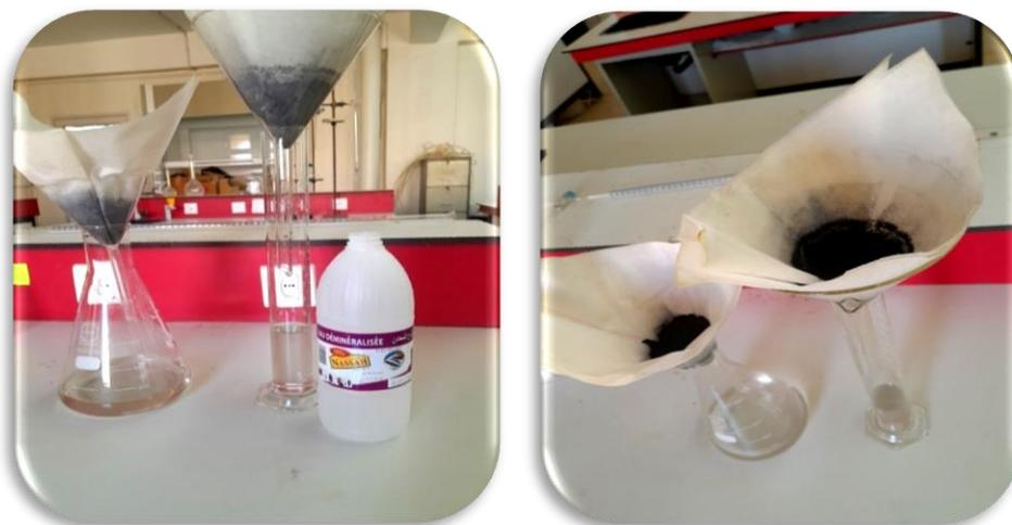
Figure.II.11 Le charbon actif après la pyrolyse, lavage et filtration
