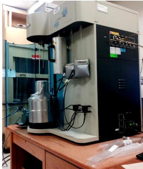
**Figure. I.16** BET - Analyse de physisorption de pores et de surfaces de haute résolution
