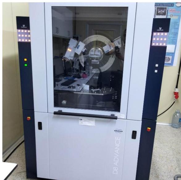
**Figure II.10.** Diffractomètre de type D8 Advance- Brucker.
