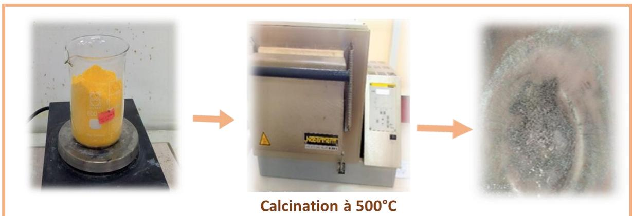
**Figure II.9.** Calcination des peaux d'orange.
