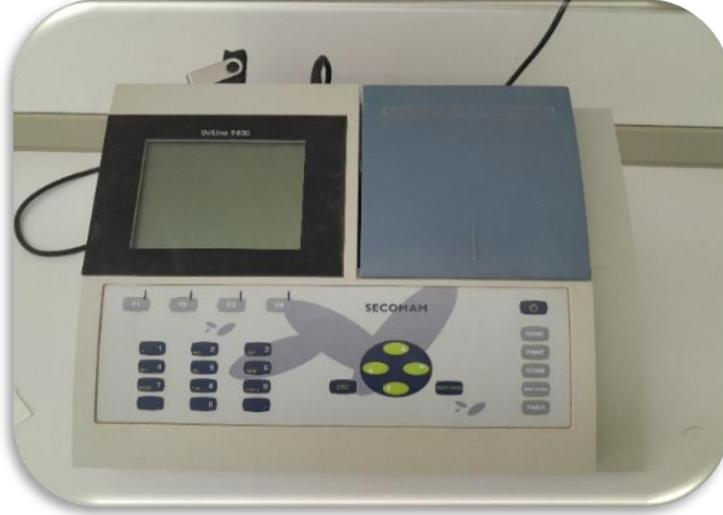
الشكل 17.II جهاز قياس مطيافية الأشعة فوق بنفسجية – المرئية من نوع UviLine 9400
