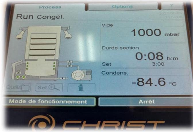
الشكل 8.II صورة لواجهة المستخدم لجهاز المجفف بالتبريد توضح طريقة أداء المجفف
