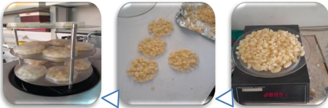
الشكل 7.II مراحل تحضير عينة الثوم قبل البدء بالتجفيف في جهاز التجفيف بالتبريد
