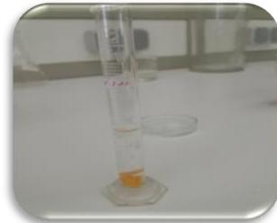
الشكل 1.III طريقة قياس الحجم المزاح لشرائح الثوم المجفف
