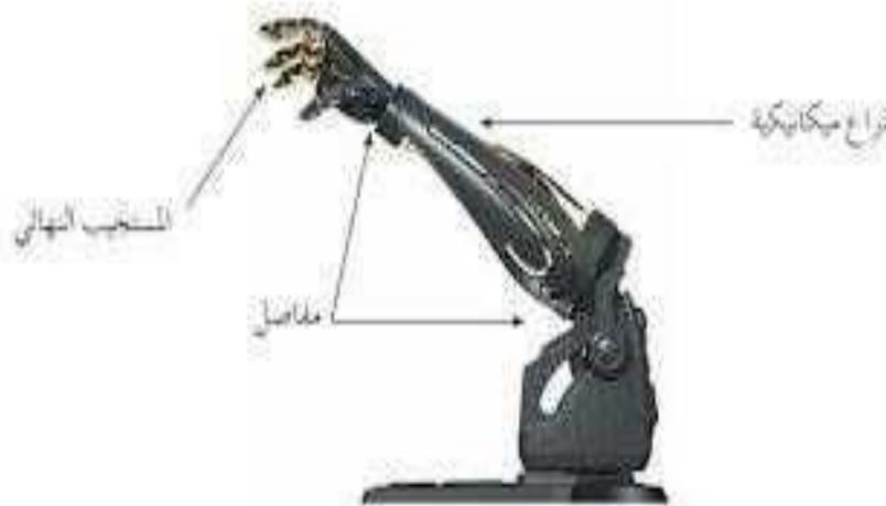
Figure1.7 Composants robotiques simples
