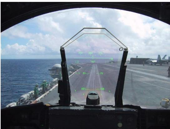
FIGURE 2.3 – Système HUD d'un F/A-18 Hornet[34]
