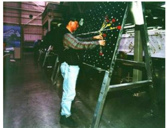
FIGURE 2.4 – Opération de câblage chez Boeing[31]
