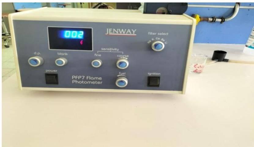
**Figure 57** : dosage de Na + et de K+ par photomètre à flamme (Photo originale).
