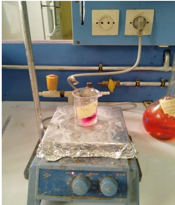
Figure 6 Détermination de calcaire actif (photo original).
