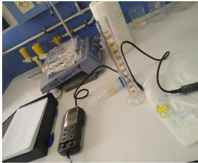
Figure 4 mesure CE par conductimètre type HI 8733 (photo original).
