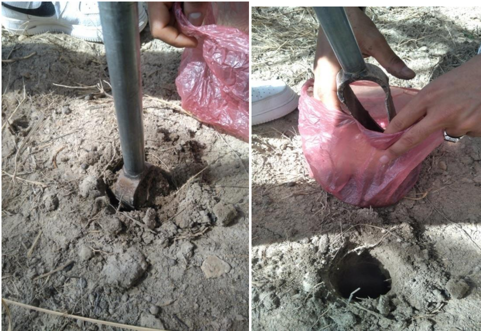
Figure 1 Prélèvement des échantillons par la tarière (photo originale).
