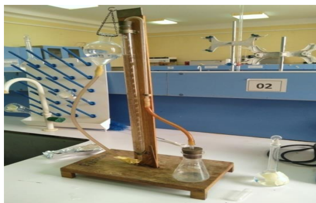
Figure 5 mesure calcaire totale (photo original).
