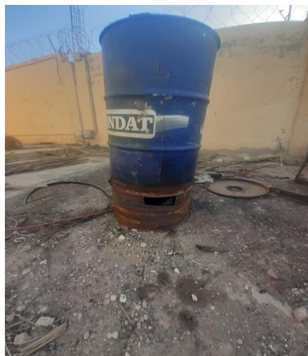
photo 6 : four à biochar dehors
