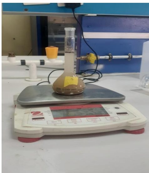
Photo 26 : la méthode de fiole pour calcul la densité réelle
