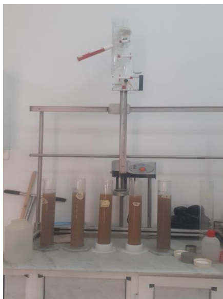
Photo 32 : réalisation d'analyse granulométrique par l'utilisation de pipette de robinson
