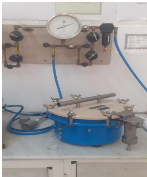
Photo 27 et Photo 28: L'appareil de Marmite Richard à l'intérieur et à l'extérieur
