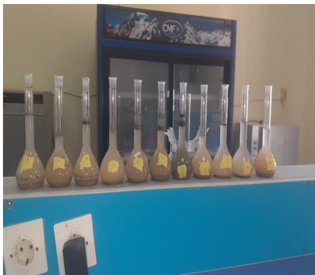
Photo 26 : la méthode de fiole pour calcul la densité réelle
