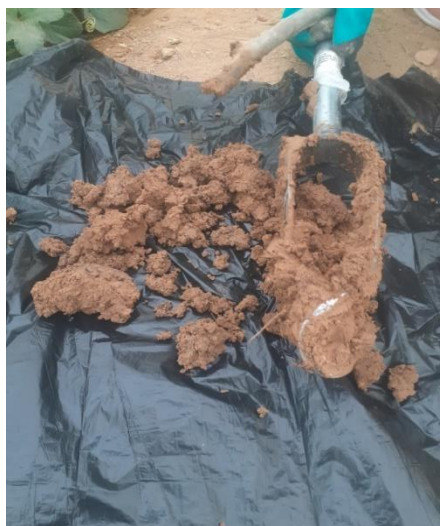
Photo 15 : méthode de prélèvement du sol dans la serre
