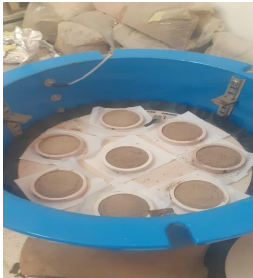
Photo 27 et Photo 28: L'appareil de Marmite Richard à l'intérieur et à l'extérieur
