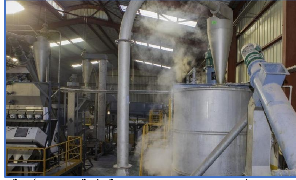
الشكل رقم 25: صورة توضح مرحلة اذابة المادة الاولية
