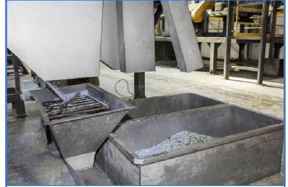
الشكل رقم 21: صورة توضح مرحلة تكسير pet
