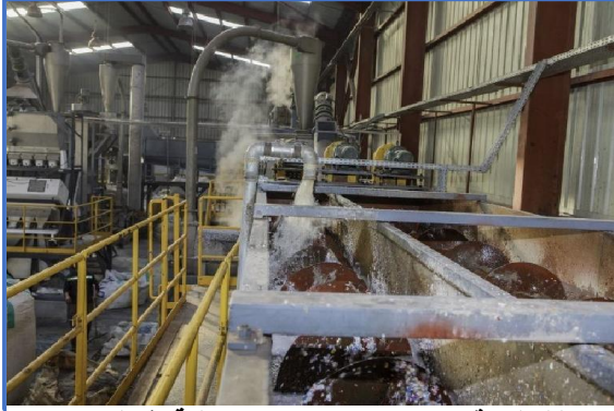
الشكل رقم 22: صورة توضح عملية غسل pet
