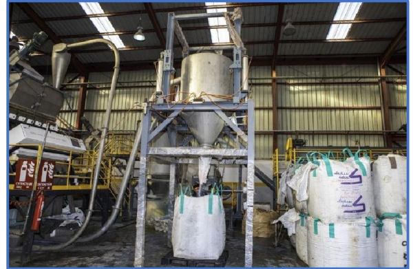
الشكل رقم 23: صورة توضح مرحلة تجفيف المادة الاولية بعد التكسير
