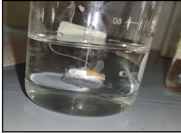
الشكل 8.II. بداية تآكل العينة في غياب المثبط
