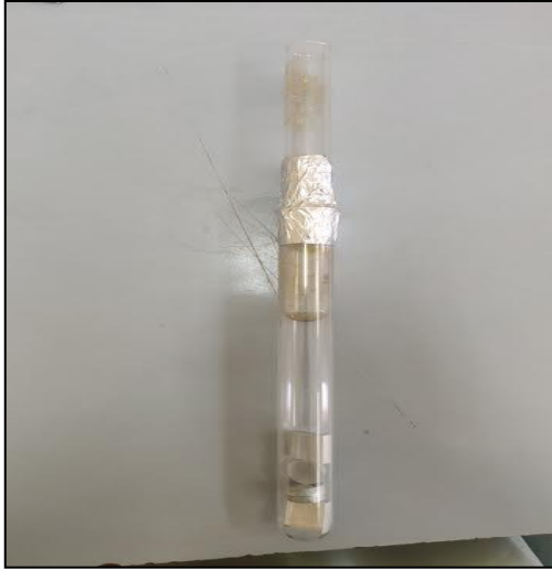
الشكل II.3. العينات قبل إدخالها للفرن
