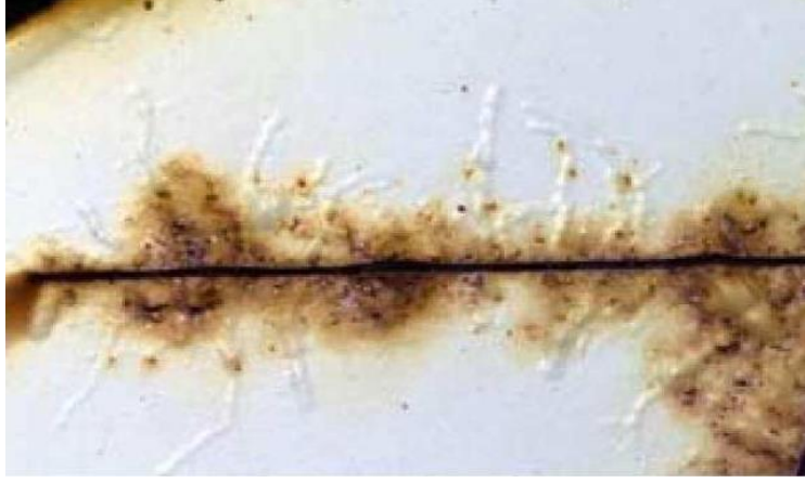
الشكل (11.1) : التآكل الخيطي [9].
