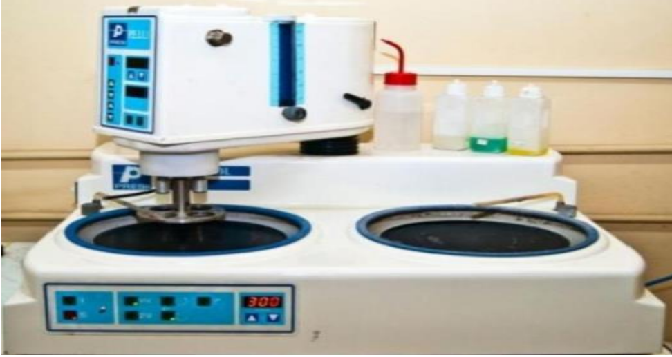
الشكل (3.11): جهاز الصقل الميكانيكي
