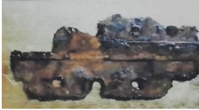
الشكل (1.1): قطعة تم إزالتها من سفينة التايتنك تعرضت لتآكل البيولوجي[17].
