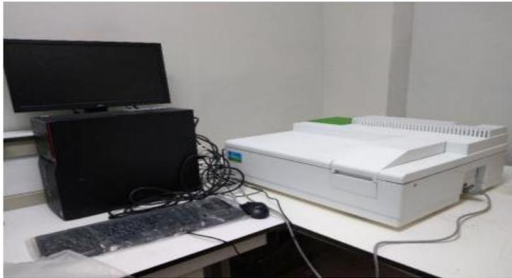
الشكل (II- 19): جهاز Perkin Elmer Lambda 35 UV/VIS
