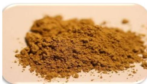
الشكل (II-2): صورة لأكسيد الرصاص PbO
