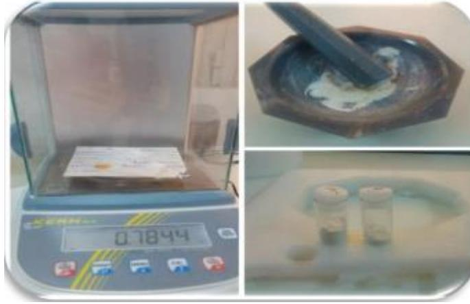
الشكل (II- 10) : طريقة وزن وطحن المواد الكيميائية
