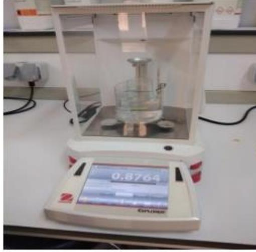
الشكل (II-16) : جهاز قياس الكثافة OHAUS
