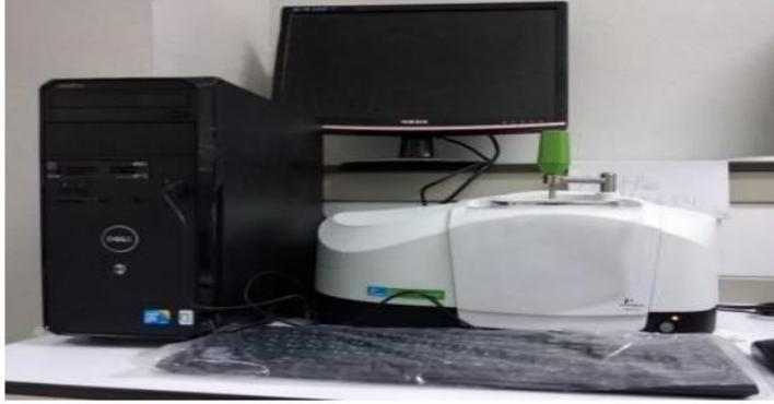
الشكل (II- 22) : جهاز مطياف الأشعة تحت الحمراء Perkin Elmer FT-IR spectrometer
