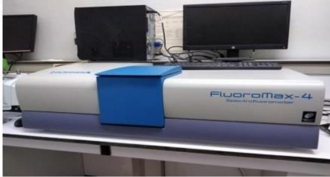
الشكل (II- 23) : جهاز قياس الطيف الضوئي spectrofluorometer
